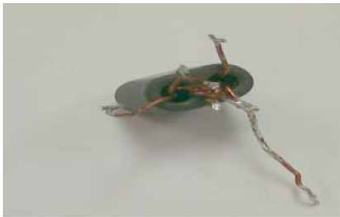
図 20 T1、25 : 1、多巻線の自動トランス
